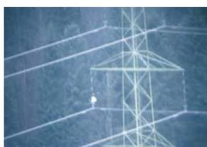
*Détection de l'effet couronne sur un pylône éloigné dans le brouillard.*
