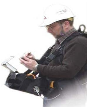
D'un point de vue ergonomique la caméra DayCor II est assez bien pensée puisqu'elle est munie d'une sangle permettant de la porter en ayant les mains libres.
