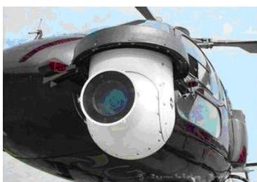
Cette technologie permet aux équipes de Symbion Power d'inspecter entre 120 et 170 km de lignes en une journée. L'inspection aérienne permet de contrôler une zone bien plus grande qu'une inspection au sol pour le même prix et dans un délai bien moindre.
