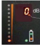
L'affichage bar graphe permet une localisation plus rapide de la source ultrasonore. La valeur affichée est la valeur crête du signal ultrasonore. Cet affichage est 5 fois plus rapide que l'afficheur numérique. Dans le cas de recherche de défauts, ce type d'affichage est utilisé pour localiser le maximum du signal.
